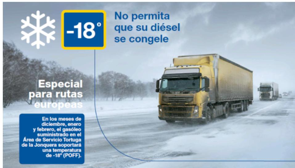
En la composición del gasóleo clásico se encuentra la parafina, un elemento que aumenta el poder calorífico de combustible pero que, a bajas temperaturas se solidifica formando pequeños cristales de parafina, que ocasiona un aumento de la densidad del combustible que termina bloqueando el filtro de entrada y la parada completa del motor.
